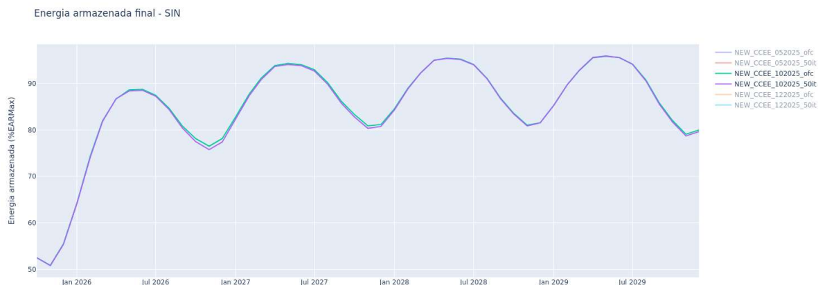
Figura 40 – Trajetória de armazenamento (EArm) para o PMO de outubro de 2025 – oficial x 50 iterações
